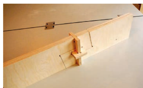
◀ L'assemblage claveté S-joint relie les éléments sans clou ni colle ni vis.
